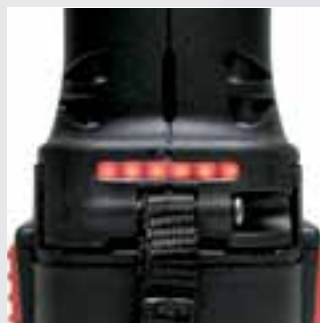
Visualizador estado de carga de la batería
