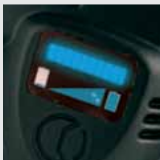
Visualizador estado de carga de la batería
