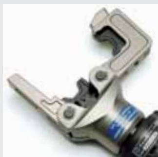
Cabeza con apertura ideal para derivaciones de conductores continuos
